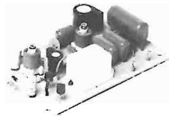
Questo ricevitore in combinazione con il trasmettitore KS 482 consente di avere una fonte sonora ausiliaria all'apparecchio telefonico, facilmente spostabile nell'ambito domestico senza bisogno di fili appositi o antenne.
