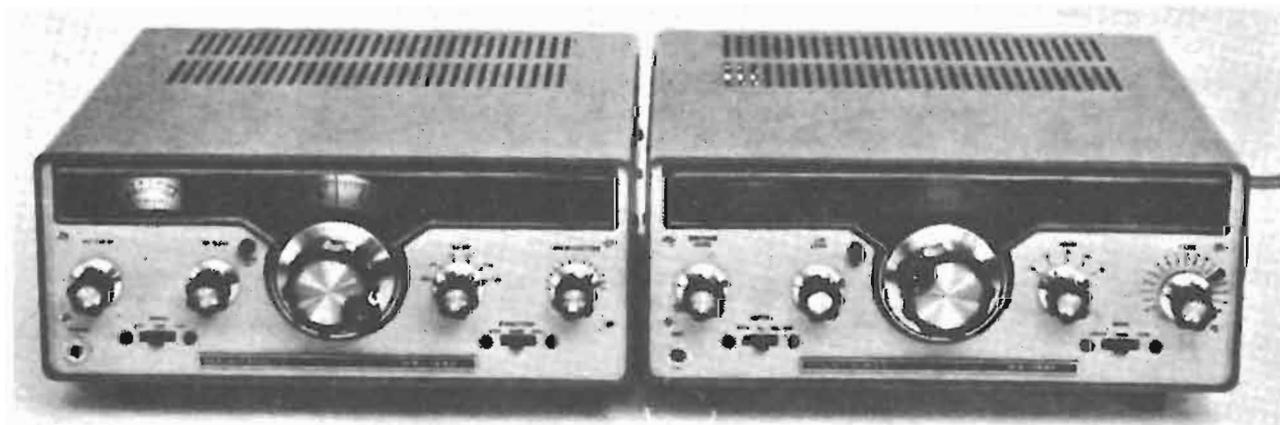
Fig. 1 - Il 1681 in compagnia del ricevitore 1680 formano una coppia armoniosa anche dal punto di vista estetico. Però si può adoperare qualsiasi ricevitore idoneo per i segnali morse — anche un Surplus.
